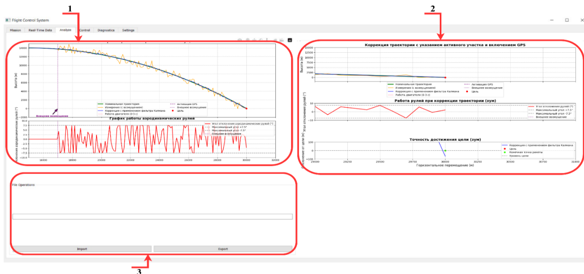
Рисунок 6 – Интерфейс «Analyze» с визуализацией траектории, скоростью, ускорением и углами рулей
