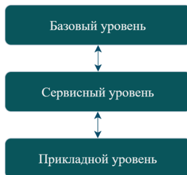
Рисунок 3 – Схема трёхуровневой архитектуры БПО
